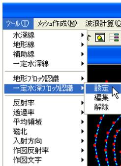
一般に海底地形は複雑であり、特に沿岸近くになると航路や泊地など等深線では表現できない人工的な地形が存在する場合があります。通常、これら人工物は一定水深の場合が多く、その領域をシステムで認識するため、一定水深ブロックを設定します。一定水深領域は、補助線以外の水深線、地形線、一定水深線で構成された閉じた領域です。メニューの[一定水深ブロック認識]-[設定]を押してください。
