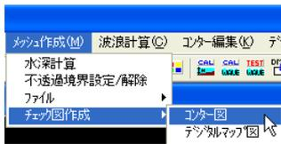
水深計算により、入力した地形・水深データから各格子点の水深を計算しました。ここでは、その格子データからプログラム内部でコンター図を発生させ、水深のコンター図を作成します。必要であれば、うまく水深計算が行われているかどうかの確認を行うことが可能です。メニューの[チェック図作成]-[コンター図]を押してください。
