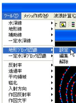
本システムで波浪変形計算を行う場合、確実に海域と陸域を区別するために地形境界を認識する必要があります。そのため、計算対象となる線分に地盤高を与える際、「水深線」と「地形線」で処理を分けています。メニューの[地形ブロック認識]-[設定]を押してください。
