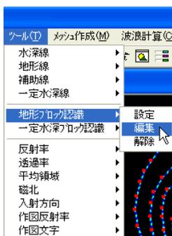
現在設定されている地形ブロックの堤体幅を変更します。堤体幅は、透過波の計算時に使用します。メニューの[地形ブロック認識]-[編集]を押してください。編集する地形ブロックのマークをマウスの左ボタンで指定してください。選択された地形ブロックが黄色で表示されます。引き続き、堤体幅を設定するダイアログが表示されます。堤体幅を変更し、**OK**ボタンを押してください。「0.0」以外を設定すれば、画面に堤体幅を表示します。
