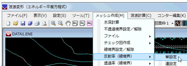
線境界1本毎に反射率を設定します。連続した線境界に一度で反射率を設定したい場合は、[反射率（線境界）]-[連設定]で反射率の設定を行ってください。
