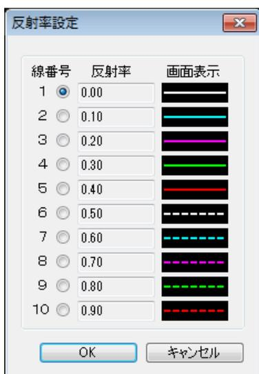
線分に設定する反射率の線番号をマウスで選択してください。OKボタンを押せば、指定した反射率が線分にセットされ、画面の表示が、ダイアログに表示されている線質に変わります。
