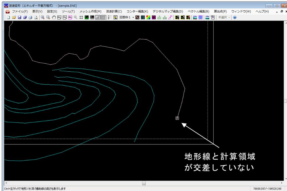
陸域を認識できなかったのは、回転により地形線が計算領域内に入ってしまい、計算領域と交差していないからです。[ツール]-[計算領域]-[修正]もしくは、一旦領域を削除し、地形線と交差するように計算領域を再設定してください。計算領域が設定できたら、[メッシュ作成]-[水深計算]を再度実行します。
