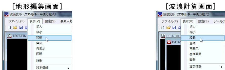
データの移動処理を行います。メニューの[移動]を押してください。マウскарソルが手に変化します。
