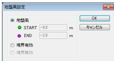
オプションボタンで「地盤高」・「境界有効」の切り替えが可能です。地盤高を選択した場合、始点（緑○）終点（紫○）に地盤高を入力します。始点、終点、もしくは両方の地盤高の入力が不可になる場合があります。これは、始点もしくは、終点がすでに水深線など高さを持った線分と接続しているため、変更できないことを示します。その場合は、オプションボタンのみ切り替えてください。
