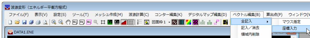
既に、ベクトル図を作図する原点位置が分かっている場合に表示原点位置を座標値で指定し、ベクトル図を作図します。図面枠毎に必ず1度は、本機能かあるいは、[全記入]-[マウス指定]機能を用いてベクトルを発生して下さい。1度もベクトルの発生を行わない場合、ベクトル図編集作業が行えません。
