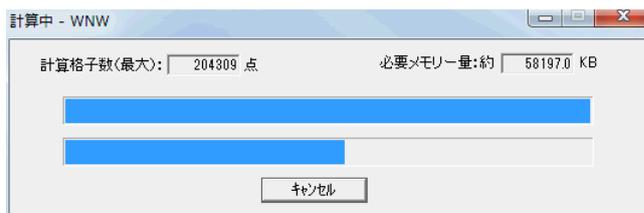
計算メッシュ点数及び、必要メモリー量が表示され、計算の進捗状況がプログレスバーにより表示されます。確認してください。途中で計算を止める場合は、**キャンセル**ボタンを押してください。
