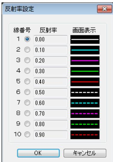
線境界に設定する反射率の線番号をマウスで選択してください。OKボタンを押せば、指定した反射率が線境界にセットされ、画面の表示が、ダイアログに表示されている線質に変わります。
