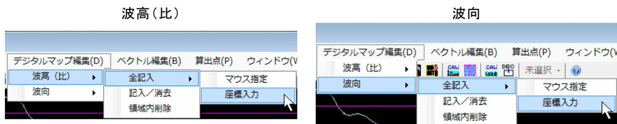
既に、デジタルマップを表示する原点位置が分かっている場合に表示原点位置を座標値で指定し、デジタルマップを発生します。波高（比）、波向それぞれ、図面枠毎に必ず1度は、本機能かあるいは、[全記入]-[マウス指定]機能を用いてデジタルマップを発生して下さい。波高（比）の場合、発生する値は波高値・波高比どちらでもかまいません。1度もデジタルマップの発生を行わない場合、デジタルマップ編集作業が行えません。
