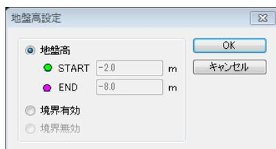
3. 地盤高入力あるいは、「境界有効」選択を行い、**OK**ボタンを押してください。属性が変更されると紺色で表示されます。始点と同じ線分を選択すると1本の選択となります。何も選択せずにマウスの右ボタンを押せば、設定モードをキャンセルします。尚、始点、終点、もしくは両方の地盤高の入力が不可になる場合があります。これは、始点もしくは、終点がすでに水深線など高さを持った線分と接続しているため、変更できないことを示します。
