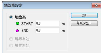
3. 必要な地盤高を入力し、**OK**ボタンを押してください。属性が変更されると反射率に対応した線質と色で表示されます。初期値では、次のダイアログの線番号1が設定されます。
