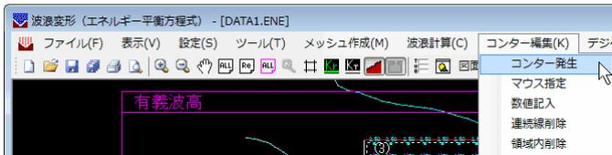
波浪計算結果を基にコンター線を発生します。図面枠、作図する値(有義波高、有義波高比、換算沖波波高、換算沖波波高比) 毎に必ず1度は行ってください。1度も本コマンドを実行しない場合、コンター編集作業が行えません。
