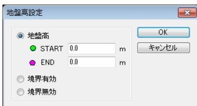
オプションボタンで「地盤高」・「境界有効」・「境界無効」の切り替えが可能です。地盤高を選択した場合、始点（緑○）終点（紫○）に地盤高を入力します。始点、終点、もしくは両方の地盤高の入力が不可になる場合があります。これは、始点もしくは、終点がすでに水深線など高さを持った線分と接続しているため、変更できないことを示します。その場合は、オプションボタンのみ切り替えてください。
