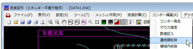
指定したコンター線を削除します。この削除は、指定したコンター線の始点から終点までを削除するものです。もしも、同一の値を持つコンター線全てを消去する場合は[コンター発生]の「任意表示」を用いてコンター線の再発生を行ってください。また、一度削除しても同一条件で[コンター発生]を行えば復元可能です。
