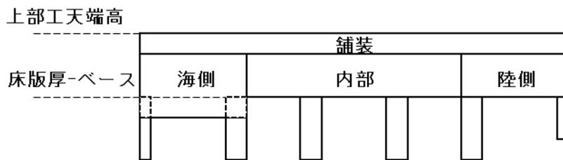
※詳細設定の床版厚によって、梁の高さが変化します。
