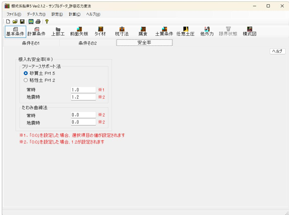
矢板根入れ長の安全率の設定を行います。基本条件－条件その1－設計基準で【港湾基準(H11)】【許容応力度法(漁港基準)】を指定した場合に選択できます。
