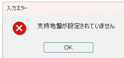
土質条件－主働側または棚杭計算用で最下層の土層の負の周面摩擦が「支持地盤」以外のものが選択されている場合に表示されます。
