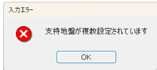
土質条件－主働側または棚杭計算用で負の周面摩擦での「支持地盤」が複数設定されている場合に表示されます。「支持地盤」は最下層1つのみ設定して下さい。
