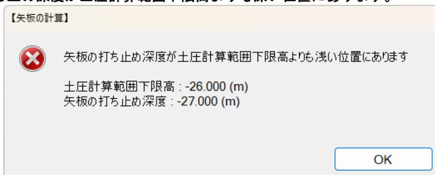
フリーアースサポート法またはロウの方法で算出された矢板の打ち止め深度が土圧計算範囲下限高よりも深い位置にある場合に表示されます。基本条件－条件その1で土圧計算範囲下限高に、矢板の打ち止め深度より深い値を設定して下さい。
